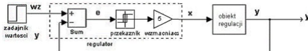
Rys. 7 Układ regulacji dwupołożeniowej
